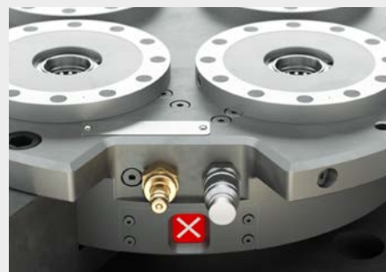
Le voyant passe au rouge lors du desserrage jusqu'à ce qu'un contrôle positif de serrage soit à nouveau effectué.
