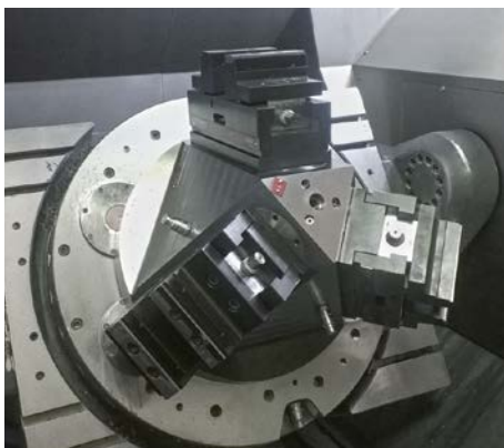
3 Werkstück-Spannsysteme HILMA.MCP in 3x120°-Anordnung auf einem 5-Achs-Bearbeitungszentrum.
